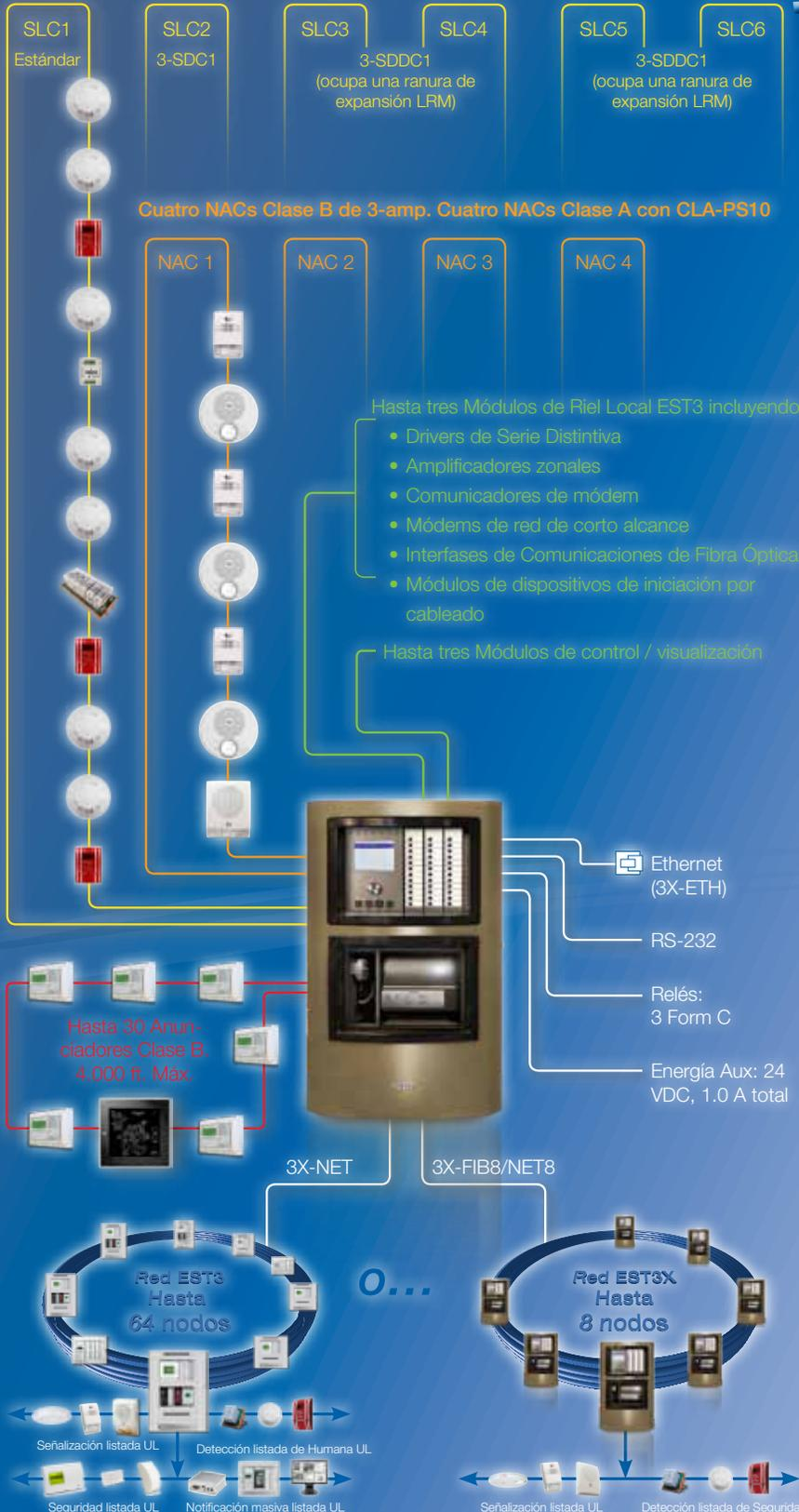
Las tarjetas de opción del EST3X le permiten sintonizar finamente cualquier aplicación para generar exactamente las características que usted necesita, al precio más bajo posible.
