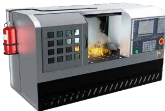
Sistema Indirecto (máquinas CNC): El 3M Novec se descarga dentro del volumen desde boquillas de supresión homologadas por UL.
